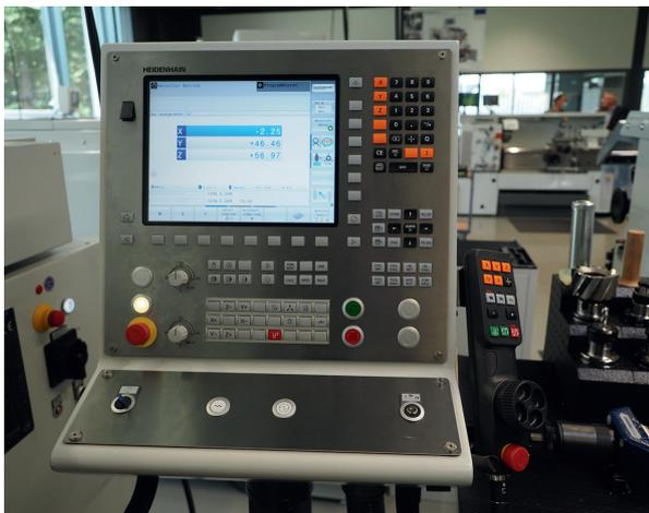
5 Die Kunzmann 'WF 410 M' haben eine Heidenhain-Streckensteuerung 'TNC 128'. Rechts das tragbare elektronische Handrad. Es ermöglicht dem Bediener beim Einrichten der Maschine nah am Arbeitsbereich der Maschine zu sein
