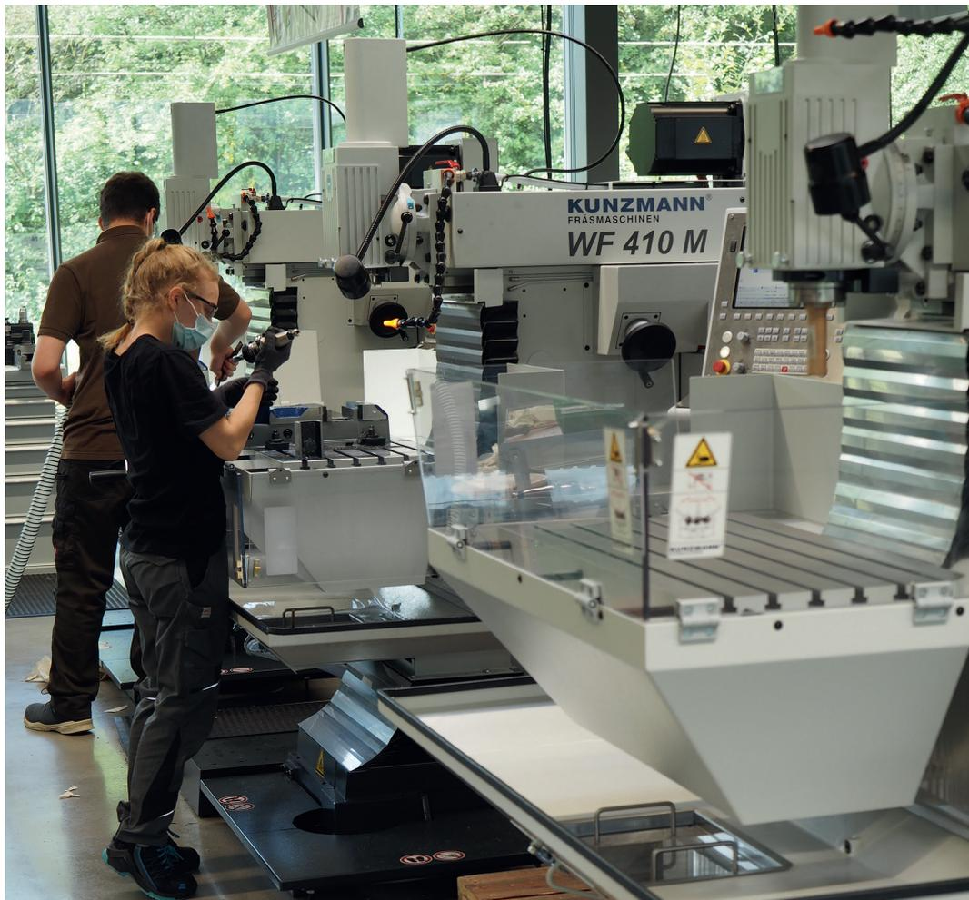
1 Im GARP Bildungszentrum: Die WF 410 M von Kunzmann sind mit einem Plexiglas-Spritzschutz am Maschinentisch ausgestattet, der nach unten geklappt werden kann © Kunzmann
